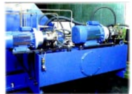
Kraftpaket med tryckreglerad axialkolvpump ger höga tryck och flöden med låg energiförbrukning.
