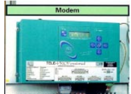
För snabb hjälp med service, felsökning eller program uppdatering kan en modem-uppkoppling direkt mot fabrik vara guld värt.
