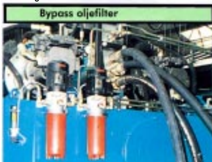
Separat oljepump till filter för kontinuerlig rening av hydraulolja förlänger oljans livslängd och minskar slitaget.
