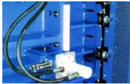
Låsning av pressplatta bakåt förhindrar skador (vid strömavbrott odyl.) Förhindrar att material i presskanalen expanderar och skjuter pressplatan bakåt med skador på bandnings mekanismens nålar.
