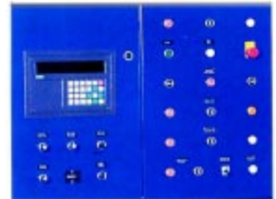
PLC från Siemens - textdialog på stor display - Gör du fel får du det i klartext. Ett minimum av knappar att hålla reda på.
