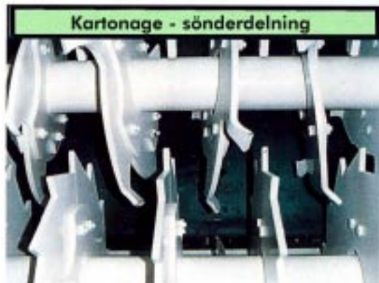
Slå sönder och mal kartonger och bulk material, ökar kapaciteten på maskin
