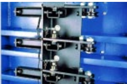
Frånslag av maskinen när ståltråd tar slut..
