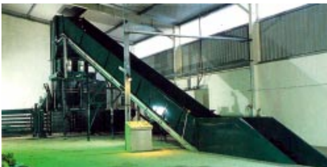
Special anpassade transportband för matning av balpressen
