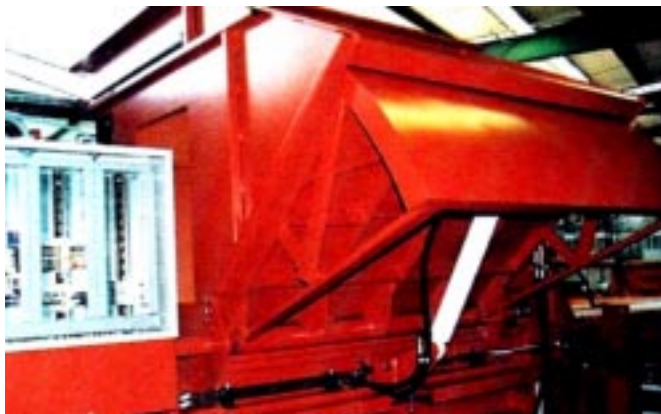
Förkomprimering snabbar på pressning av volumiöst material. Hydraulisk sidoklaff trycker ner material mot botten av inmatningstratten.
